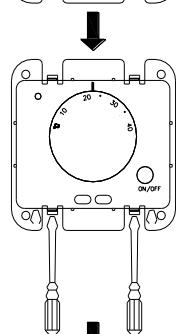
Снимите рамку с терморегулятора,
